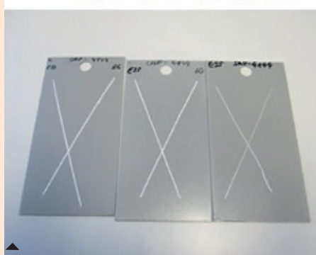
Photo: Résultat de test PreCoat CR Free après 3000 heures de brouillard salin
