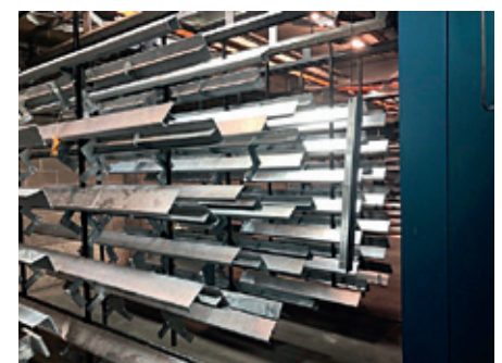
Verzinkt materiaal, klaar voor de straaltunnel
