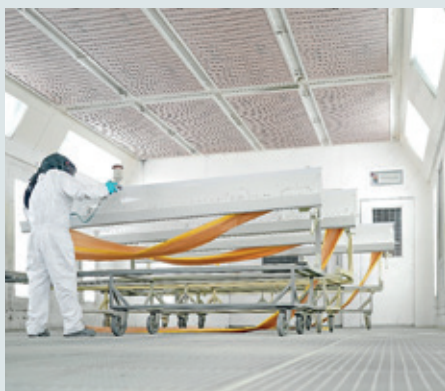
▲ Mise en peinture d'un bord d'attaque d'aile d'avion.
