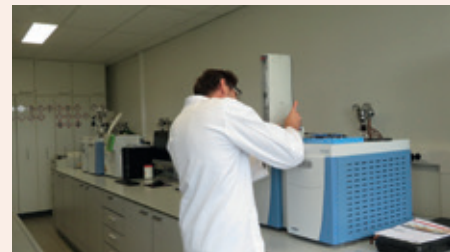
HAP et PCB analysés à OCAS par chromatographie gazeuse - spectrométrie de masse (GC-MS)
