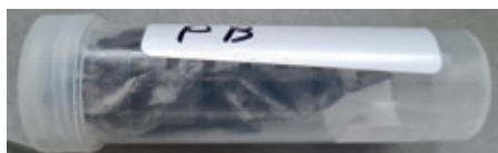
▲ Stofbemonsteringsdoekje voor analyse van lood in een tunnel
