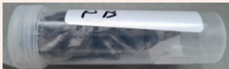
▲ Lingette de prélèvement de poussières avant analyse du plomb présent dans un tunnel
