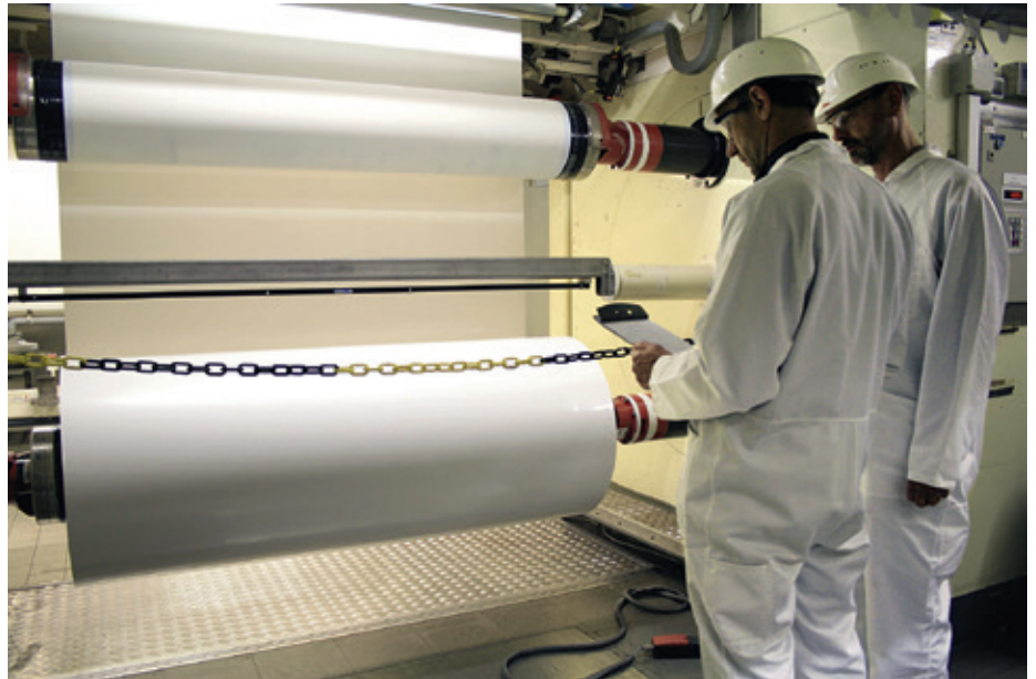
De productie van Synaps, synthetisch papier, waarbij een warmtebehandeling na bi-axiaal rekken zorgt voor behoud van mechanische eigenschappen.
