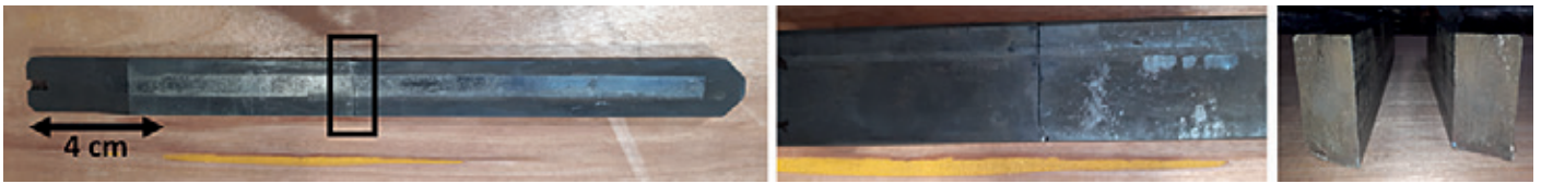
Photo 1: Rail en acier X210Cr12 trempé/revenu fissuré
