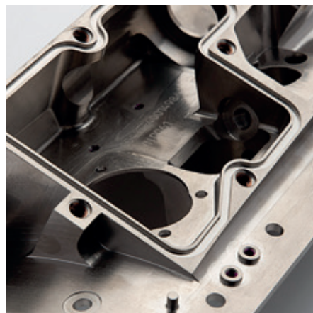
Photo 2. Pièce complexe nickelée chimiquement
