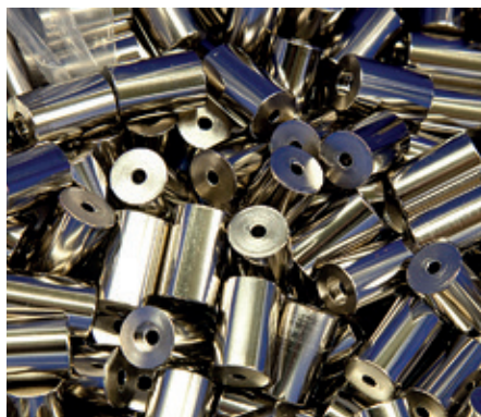
Photo 5. Pièces traitées avec du nickel chimique dur
