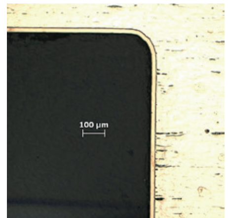
Photo 3. Épaisseur de couche uniforme sans effets de pointe
