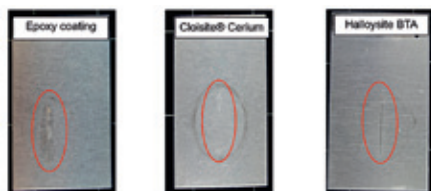
Figure 5: Substrats d'Al avec un revêtement epoxy (1), un revêtement époxy avec incorporation d'argile modifiée avec du Cérium (2), et un revêtement époxy avec incorporation d'argile modifiée avec du BTA (3) suite à un test au BS.
