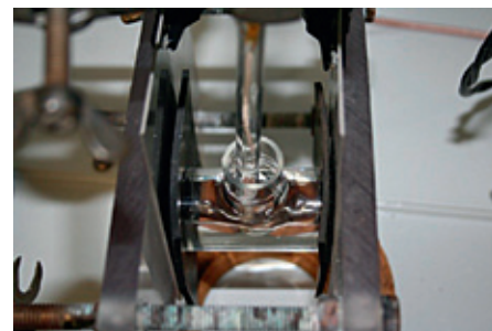
▲ Figure 2 – Exemples de cellules électrochimiques à trois électrodes
