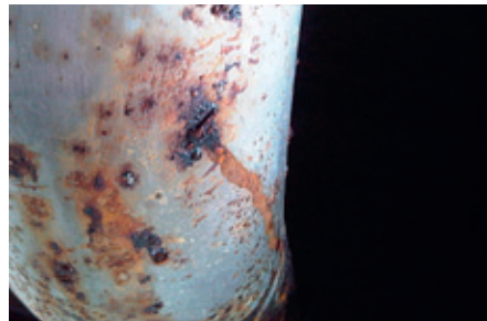
Fig. 3: phénomène d'exsudation propre à la corrosion par piqûres
