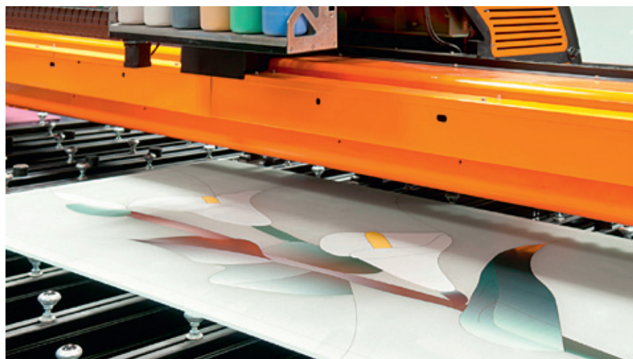
▲ L'impression s'effectue via le principe du jet d'encre et est entièrement contrôlée par CNC. L'impression se fait en un seul passage, ce qui permet un gain de temps et de matériel important.
