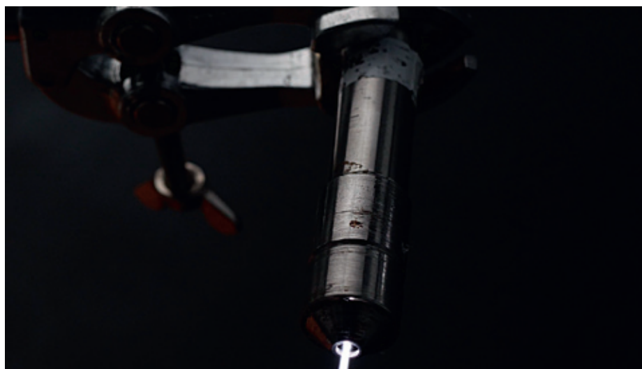
Torche IONJET en fonctionnement
