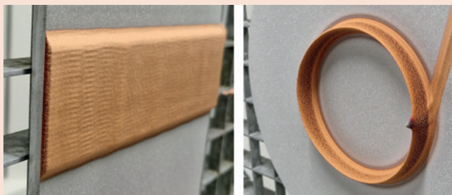
Figure 3: Exemples de dépôts de cuivre par cold spray sur aluminium (épaisseur 4 mm à gauche et 15 mm à droite)
