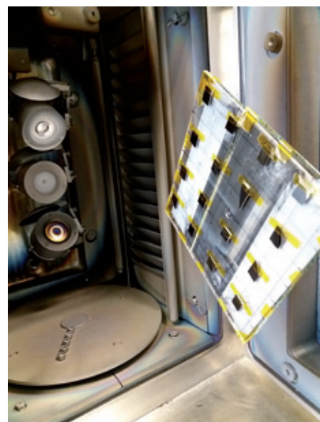
▲ Pulvérisation magnétron a) Exemple de système de co-pulvérisation avec trois cibles
