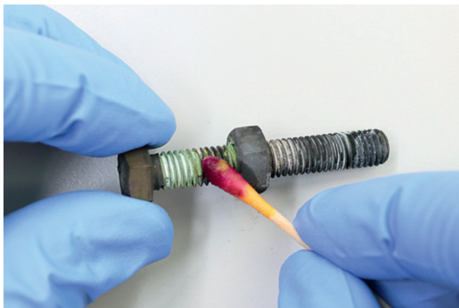
▲ Figuur 2. Voorbeeld van een RVS 304 (A2) bout en moer met anti-vastloopp middel na warmtebehandeling. Het gevormde gelige chromaat is duidelijk zichtbaar. De TKI I® chroom-6 detectie teststaaf verkleurt duidelijk rood/paars, wat erop duidt dat er chroom-6 aanwezig is.
