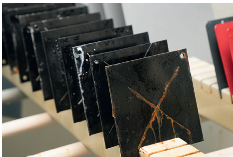
▲ Zoutsproeitest: testplaatjes in de zoutneveltest
