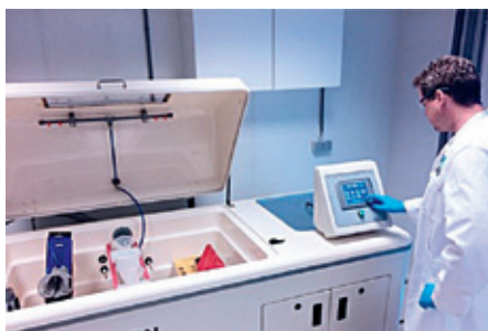
▲ voorbeeld van een cyclische corrosietest
