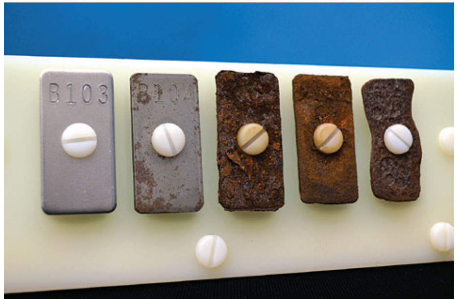
Er werden verschillende technieken geïntroduceerd die de prestaties van testkamers controleren om ervoor te zorgen dat consistente corrosieve omgevingen worden overgedragen aan de monsters. Deze omvatten het gebruik van standaard referentie massaverliescoupons of corrosiecoupons.
