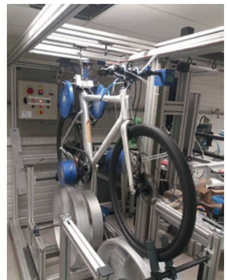
▲ testopstelling voor het nagaan van schok- en trileffecten
