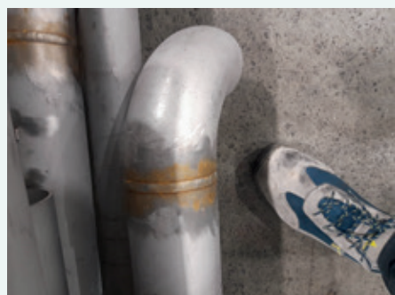
▲ Exemple d'un cordon soudure brossé mais pas traité chimiquement présentant un départ de corrosion
