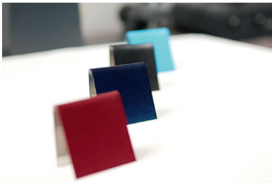
Figure 2: exemple de revêtements sol-gel colorés sur acier inox ensuite soumis à un test de pliage sur mandrin cylindrique: ces revêtements hybrides organique-céramiques sont flexibles!
