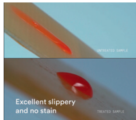
▲ Exemple de surface à effet de glissance offrant un effet d'auto-nettoyabilité aux surfaces (CIDETEC) ( http://www.chopin-project.eu/Technologies/ )
