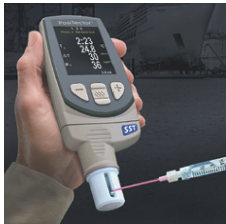
PosiTector SST Oplosbare Zouttester
