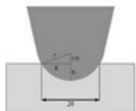
◀ Een geometrische beschrijving van een stylus-tip
