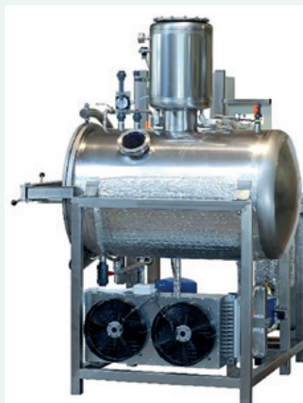
PHOTO 2 Une étape d'évaporation supplémentaire peut être obtenue avec la série ES DRY. Cela permet d'obtenir un épaississement supplémentaire du concentré.
