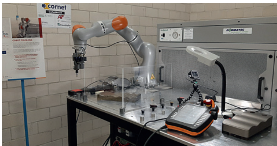
▲ Cobotpolijstcel bij SIRRIS
