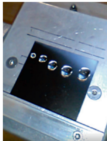
▲ Mesure d'angle de contact (au dessus) et mesure d'angle de glissance (au dessous)
