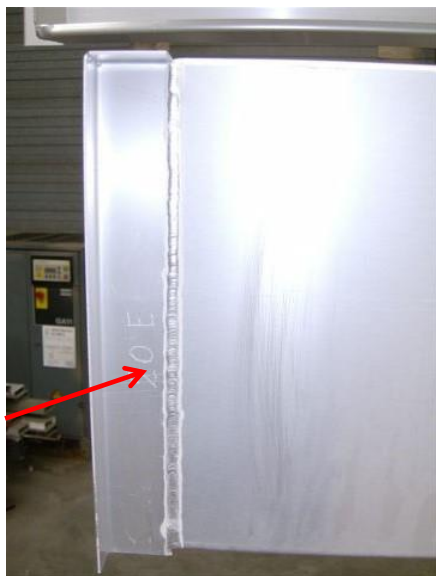
Foto: Voorbeeld van een gravure die zichtbaar blijft na het lakken.
