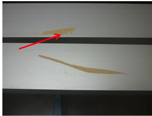
Foto 2: moeilijk te verwijderen verpakkingskarton op brut aluminium als gevolg van te vochtig stockeren.
