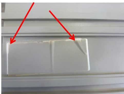
Foto 1: Het identificatielabel verschuift en komt los met als gevolg onvolkomenheden in de laklaag rondom het label.
