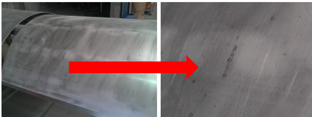
Foto 1 en foto 2: voorbeelden van vreemde substanties (stipjes) op aluminium plaat (uitvergroting)
