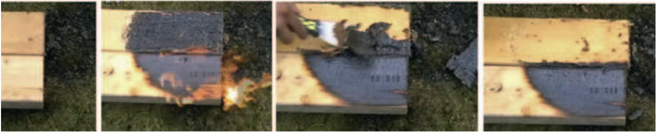
Figuur 4: Test uitgevoerd op hout behandeld met een nano-coating om brandresistentie te verhogen (bovenste paneel) en onbehandeld houten element (onderste paneel) voor en na brand [5] .
