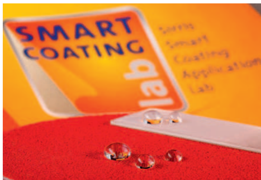
Figuur 3: Een druppel water op een super-hydrofoob oppervlak rolt bij de minste helling van het oppervlak af.
