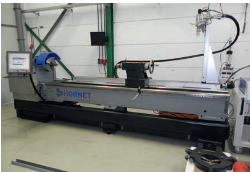
Laser cladding opstelling bij CZL Tilburg
