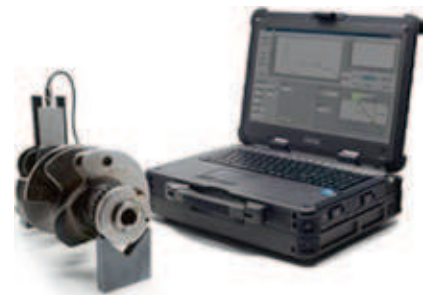
Figuur 2: In situ meting van een hardingsdiepte d.m.v. P3123 Tester
