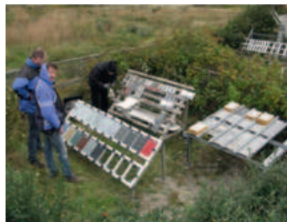
Fig. 4 de testpanelen op land in een maritieme atmosfeer
