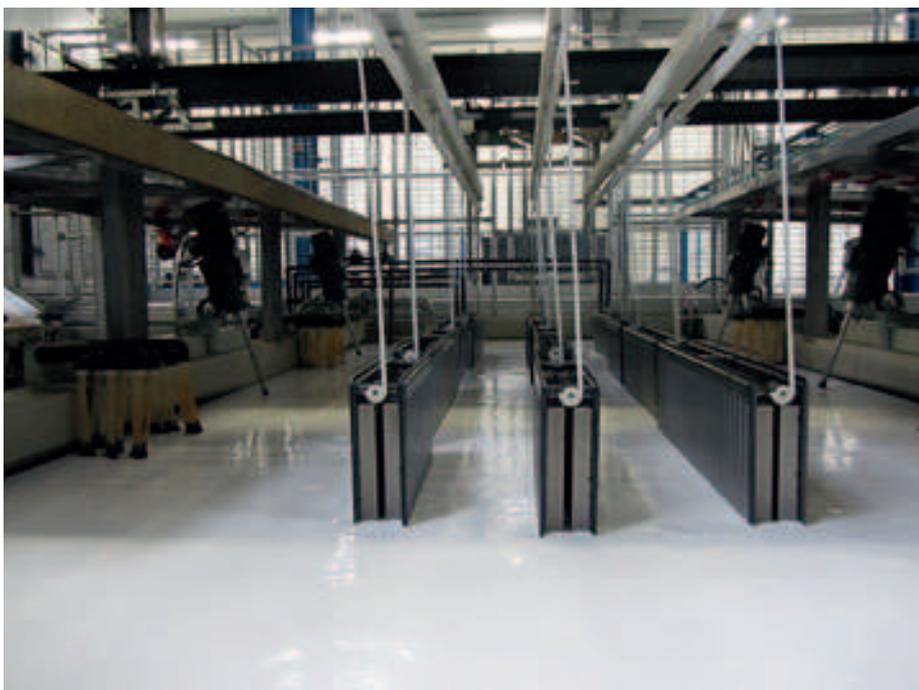
Fig. 3: radiateurs en cours de trempé dans la cuve de Bonderite M-PP 102. Un simple séchage à 90°C sera nécessaire avant peinture poudre.
