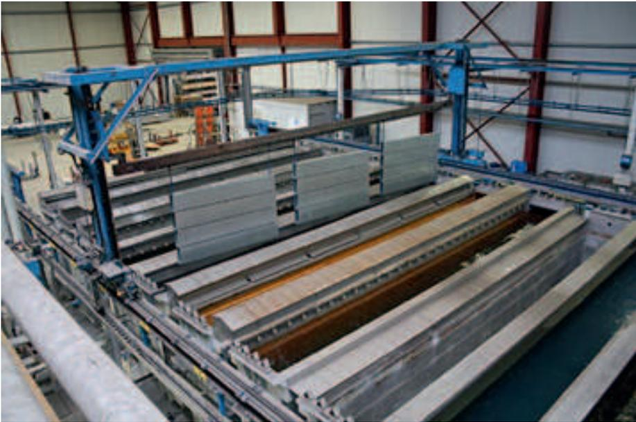
Fig. 1: la ligne de production de Räckers utilise le procédé de revêtement sans électricité Bonderite M-PP 930 pour protéger durablement des pièces métalliques contre la corrosion. Räckers bénéficie de la co-cuisson pour la Bonderite M-PP 930 et la poudre.
