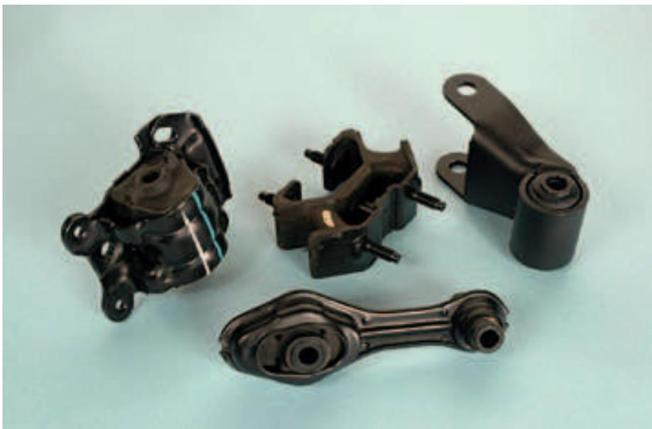
Fig. 2: des composants automobile caoutchouc - acier peuvent passer sans problèmes dans l'étuve à 90°C servant à l'étuvage de la Bonderite M-PP 866.
