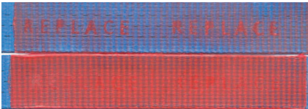
Figuur 8: sjorband voor ladingsekerings met UV gevoelige print. De waarschuwingstekst wordt leesbaar bij overmatige UV blootstelling (boven).
