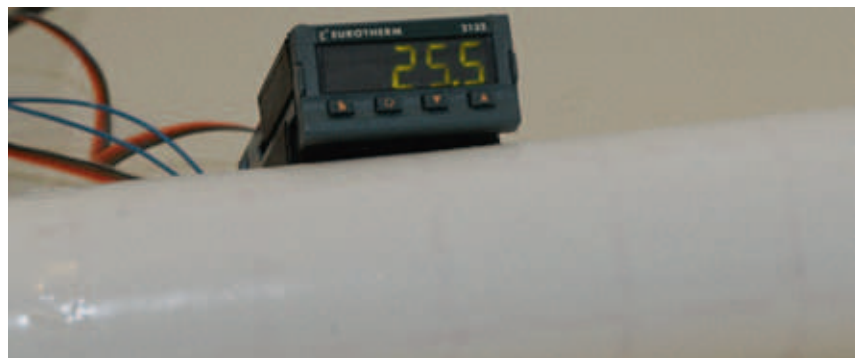
Figuur 5: elektronische temperatuur sensor geïntegreerd in een tentzeil.
