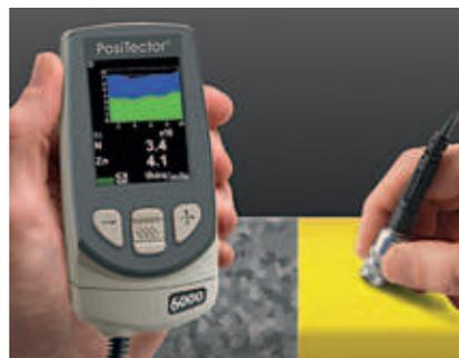
De FNDS Sonde meet individuele laagdiktes van zink en verf in een dubbel coating-systeem – Geavanceerd model op de foto met real-time grafieken.
