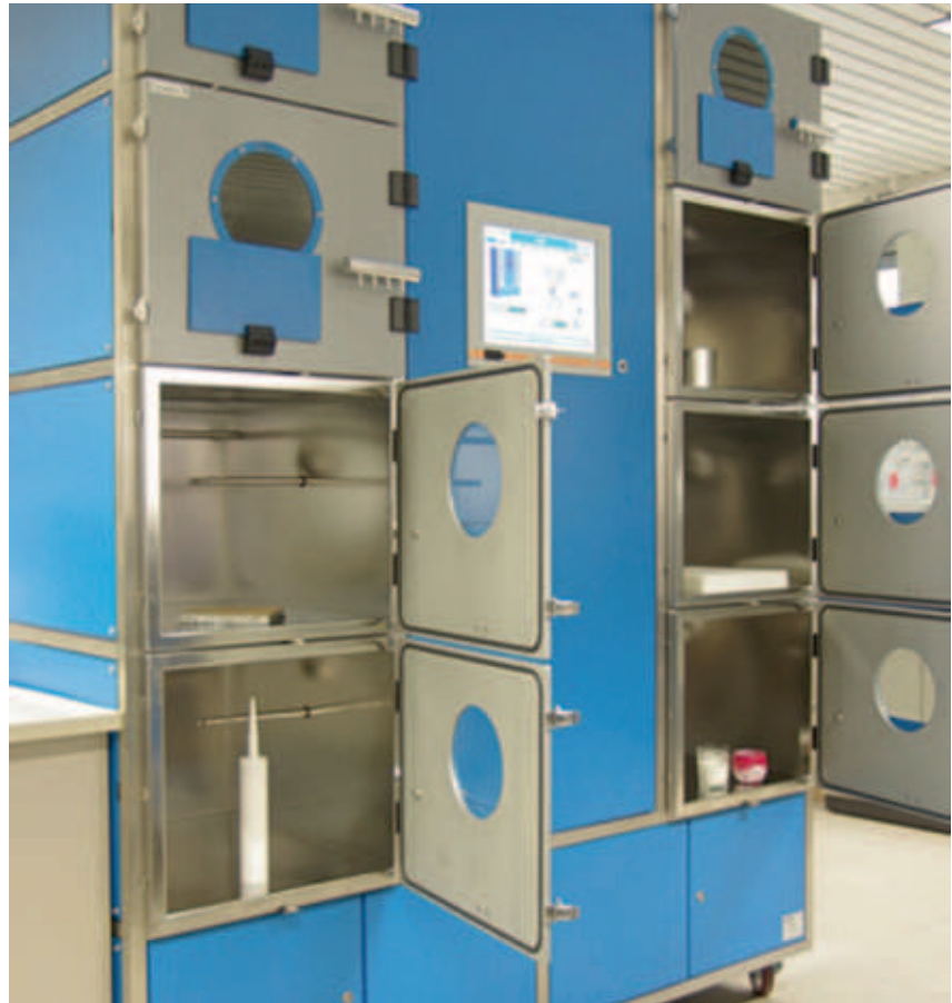
Voorbeeld van een emissie testkamer
