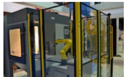
in het stralen van vleugeldelen in de luchtvaart." Ten slotte is een combinatie van de eerste twee segmenten mogelijk. Hierbij tilt de robot het product op en beweegt het product langs een vast opgestelde straalnozzle. Een voorbeeld hiervan is te vinden in de automotive-sector, bij onder andere het stralen van klepstoters. Leering Hengelo wordt in België vertegenwoordigd door Inplasco.
