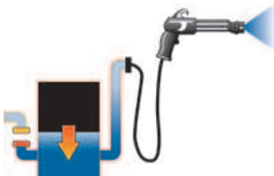
Als het spuitpistool wordt ingeschakeld, wordt de verbinding tussen het verfreservoir en de geaarde voorraad onmiddellijk verbroken. Een luchtspleet voorkomt dat de elektrostatische lading via het systeem wegvloeit.
