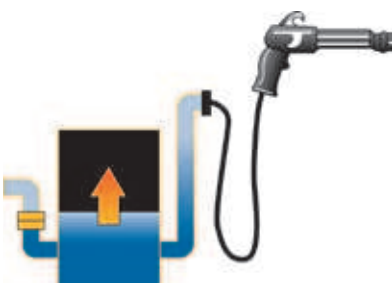
Als het spuitpistool uitgeschakeld is wordt verf aangevuld vanuit het geaarde voorraadreservoir.
