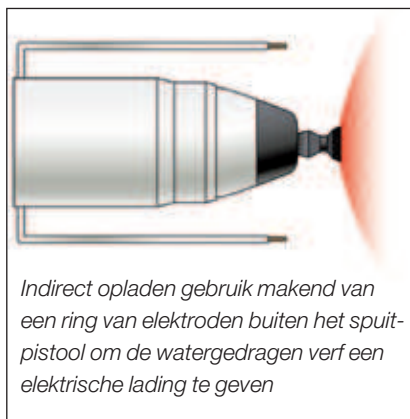
Als het spuitpistool wordt ingeschakeld, wordt de verbinding tussen het verfreservoir en de geaarde voorraad onmiddellijk verbroken. Een luchtspleet voorkomt dat de elektrostatische lading via het systeem wegvloeit.
