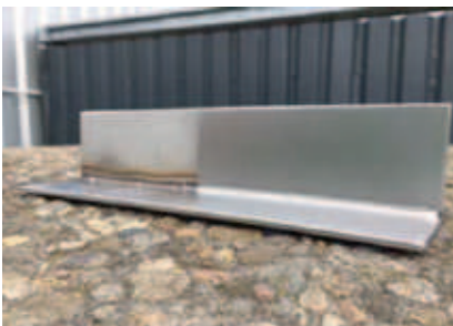
Fig. 4: de rechterhelft is behandeld met het PureFinish proces
