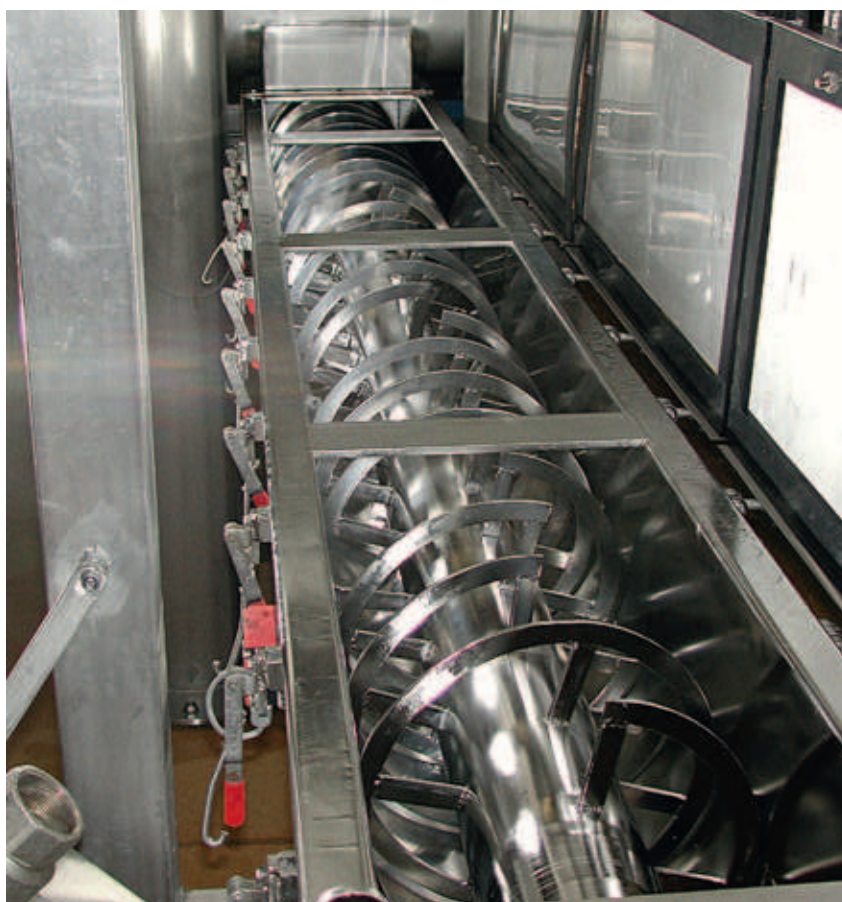
Archimedesschroef na ontzwaren voor zetmeeltoepassing
