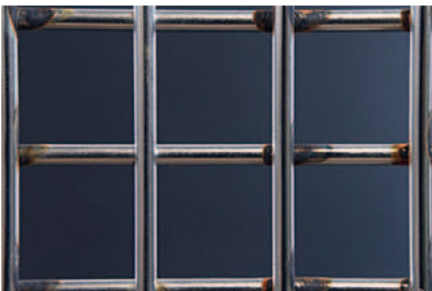
* Figuur 1 Draadwerk 5 \mu\text{m} glansnikkel, 0.15 \mu\text{m} Cr. a) onbehandeld na 24h zoutsproeitest NSS.
