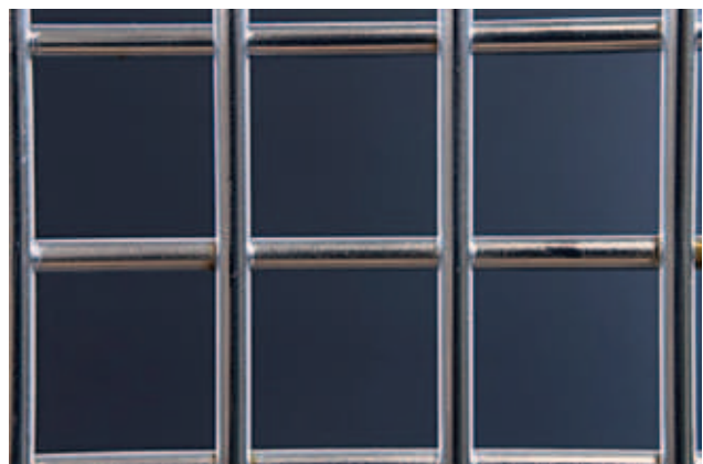
* Figuur 1 Draadwerk 5 \mu\text{m} glansnikkel, 0.15 \mu\text{m} Cr. b) behandeld na 72h NSS
