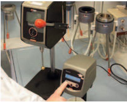
Bepaling van de viscositeit van soep m.b.v. een rotatie viscometer. Op de achtergrond verschillende viscositeitsbekers
