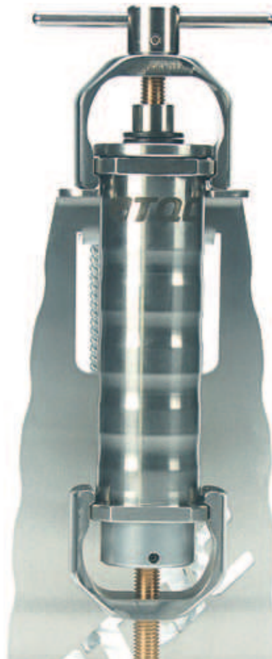
Met behulp van de Druk Pyknometer is de dichtheid van elke vloeistof, van verf tot saus, te bepalen
