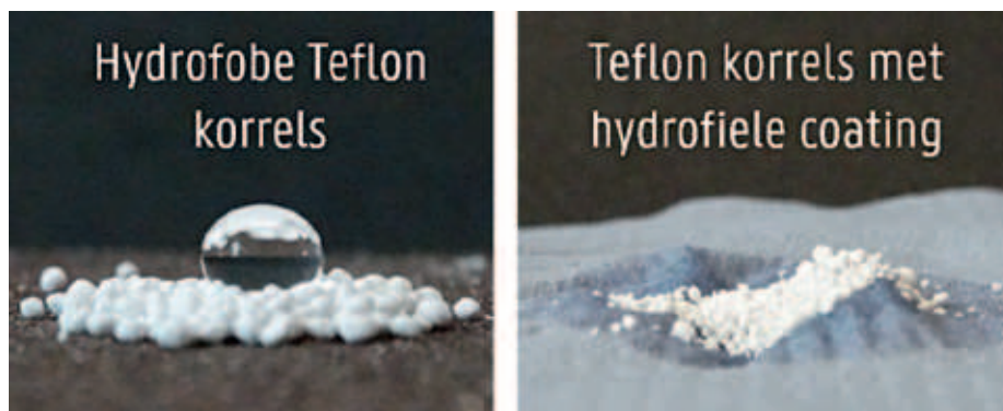
Figuur 3: Hydrofobiciteit van ongecoat en ALD gecoat Teflon
