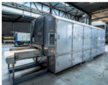
▲ Een tunneloven systeem (MEAM DRY S20, 12 m. lang) van 20Kw met een transportband feeder van 1 m. breed
