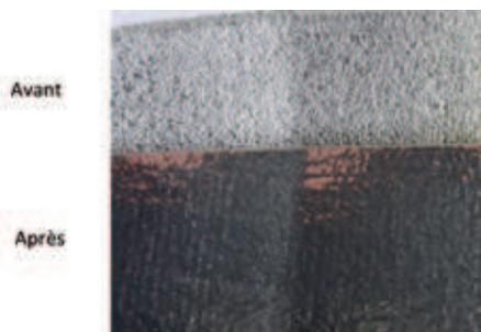
▲ Evolution de l'état de surface obtenue par additive manufacturing: avant et après usinage chimique
