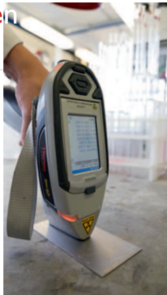
Afbeelding 1: XRF testen gebruikt voor het uitmeten van het metaaloppervlak
