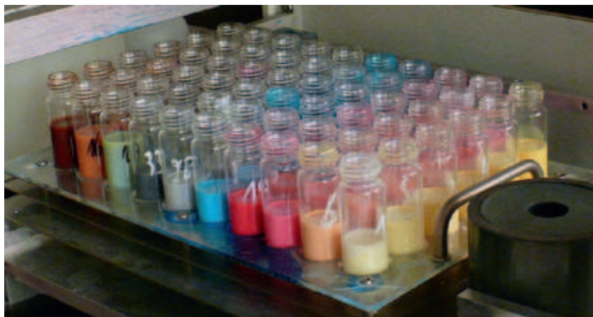
High Throughput bereiding van 60 dispersies in kleine hoeveelheden
