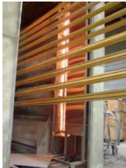
Foto 6: de brander met exact dezelfde afmetingen 800 x 100 mm en dezelfde bevestiging
