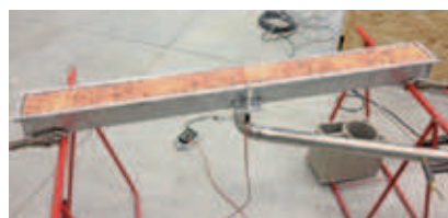
Foto 1-3: links boven: het metaalvezel breisel; rechts boven: dit breisel gloeiend door de verbranding van een gas/lucht mengsel; foto onder: een infrarood stralende metaalvezelbrander
