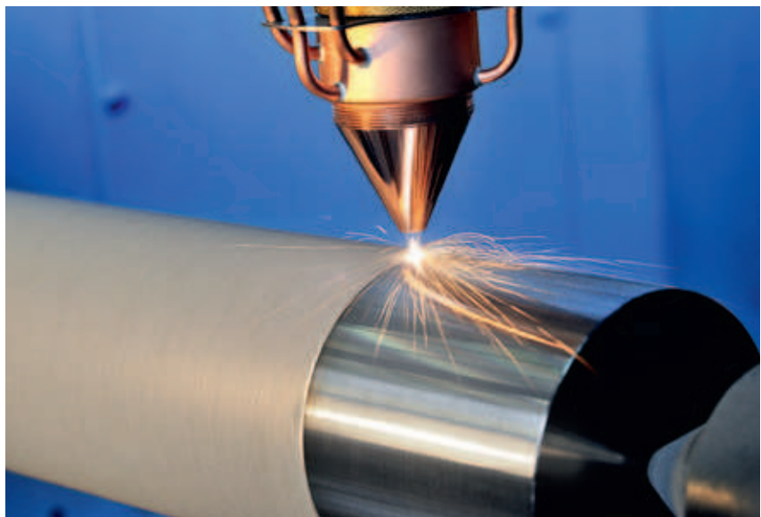
Laser cladding, foto aangeleverd door Fraunhofer ILT
