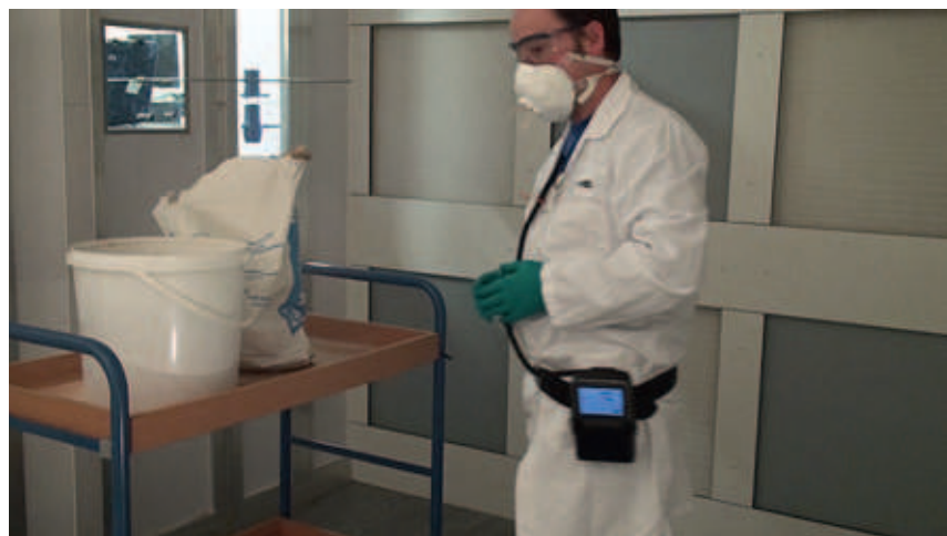
Figuur 1. Meten van de persoonlijke blootstelling met een draagbaar apparaat.
