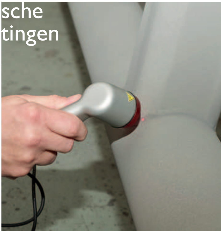
▲ Ook in hoeken kan de laagdikte worden gemeten
