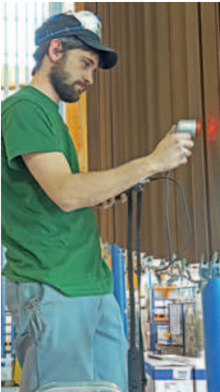
▲ Drie LED-pointers, die bij een juiste meetafstand tot een lichtpunt samensmelten, helpen de gebruiker om het meetpunt te positioneren.
