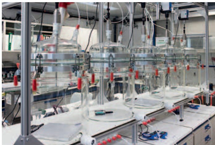
◀ Rijen van testkamers om productemissies of reductie van vluchtige organische stoffen te meten.
