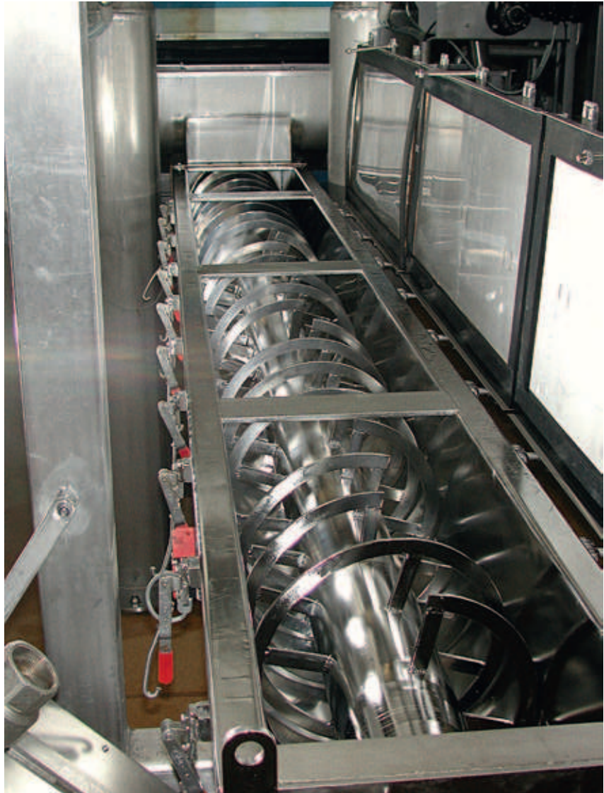
Figuur 1 - tegen aankleven van zetmeel: Amorfiseren zorgt voor een lagere wrijvingsweerstand en een betere reinigbaarheid.
