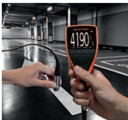
La jauge de mesure d'épaisseur de revêtements Elcometer 500 mesure avec précision et de manière non destructive l'épaisseur de revêtements sur béton et autres substrats similaires.
