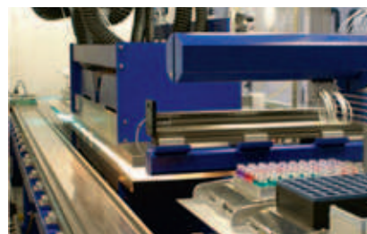
Figuur 8: High-throughput platform voor versnelde applicatie en processing van coatings.
