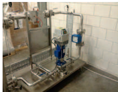
Figuur 3: Flow loop voor drag reduction metingen van coatings in water.
