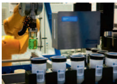
Figuur 6: High-throughput platform voor versnelde aanmaak van formuleringen.
