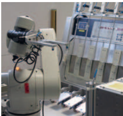
Figuur 5: Versnelde screening van weerstand tegen UV, temperatuur, vochtigheid en chemicaliën.
