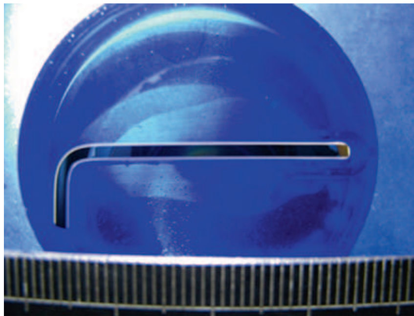
Dwarsdoorsnede van de gecoate structuur. Rechts bevindt zich de "probleemrand".
