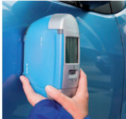
de l'automobile d'établir des spécifications plus ou moins indépendantes de la teinte, de la saturation, de l'effet de lumière et même de l'angle d'observation ( $\Delta E_{DIN6175-2}$ ). La mesure de la couleur sous plusieurs angles ne suffit pas pour définir le changement d'apparence dans des conditions d'éclairage différentes, il faut également mesurer le scintillement et l'effet de texture.
