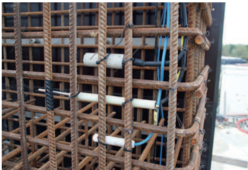
Toepassing in een structuur van een ER probe (midden) en referentie-elektrode (onderaan)
