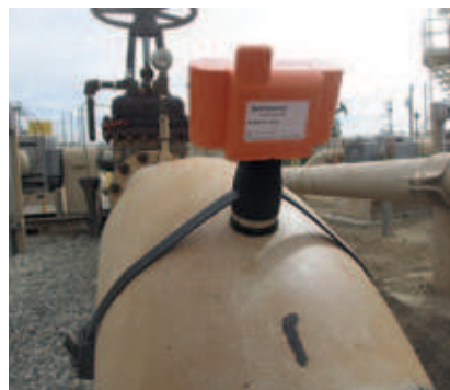
Permanente ultrasone diktemeting op een pijpleiding (beeld eigendom van PermaSense)
