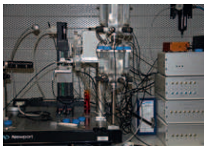
Figuur 3. Geautomatiseerde parameter screening, d.m.v. scanning flow cell, geeft corrosietesten een boost.
