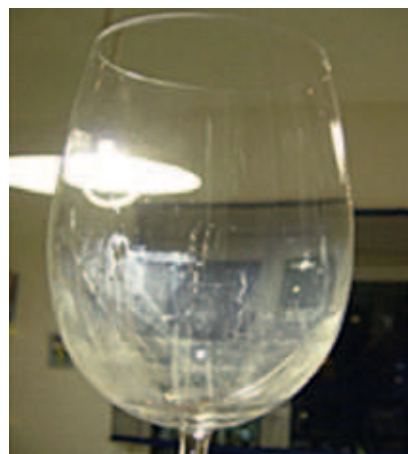
Figuur A.4. 'Corrosie' van glas
